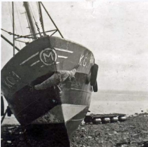
de KG 1 op de slikken te Colijnsplaat tijdens laag water voor het teren van de onderkant voor onderhoud
